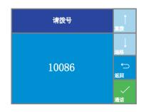
★ 在下述任一状态下,通话操作将被禁止:GSM网络异常、布防状态、通话报警中。
